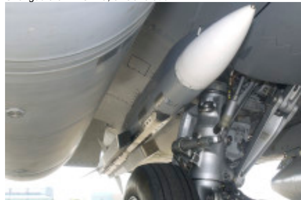
Lenkwaffe MBDA Meteor 28 : 200 Km Reichweite mit Mach 4+
