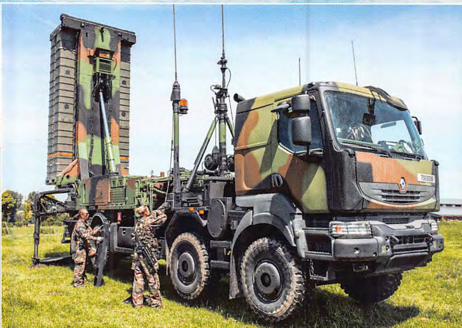
Der Werfer kann innerhalb Sekunden Aster 30 Raketen auf verschiedene Ziele abfeuern.
